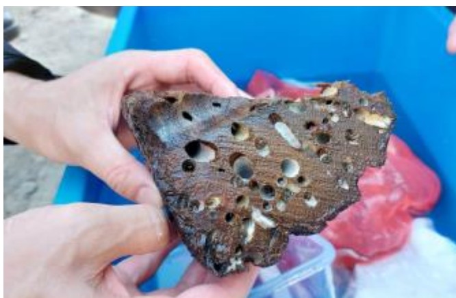
銅網がはがれた箇所から採取した船体の一部
